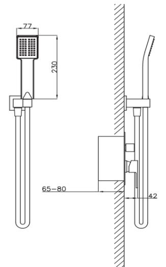
Conjunto de ducha monomando empotrado de 2 vías. Rociador cuadrado de Acero Inox.S304 de 25cm. Ultrafino y antical. Soporte de mango de ducha orientable, con salida de agua a pared. Flexo de PVC 1,5m. Mango de ducha cuadrado. **Caja de registro incluida.** Profundidad para empotrar 65-80mm.
