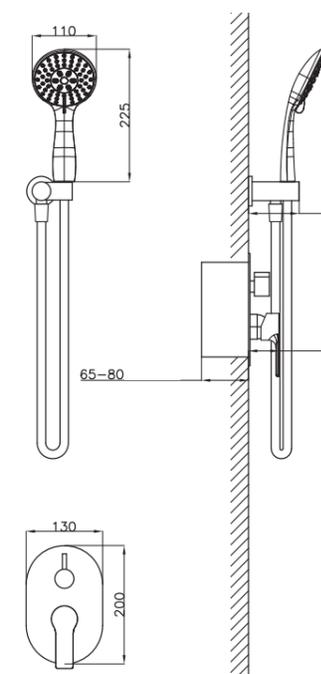
Conjunto de ducha monomando empotrado de 2 vías. Rociador redondo de Acero Inox.S304 de 25cm. Ultrafino y antical. Soporte de mango de ducha orientable, con salida de agua a pared. Flexo de PVC 1,5m. Mango de ducha redondo con 3 funciones. **Caja de registro incluida.** Profundidad para empotrar 65-80mm.
