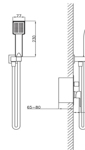
Conjunto de ducha monomando empotrado de 2 vías. Rociador cuadrado de Acero Inox.S304 de 25cm. Ultrafino y antical. Soporte de mango de ducha orientable, con salida de agua a pared. Flexo de PVC 1,5m. Mango de ducha cuadrado. **Caja de registro incluida.** Profundidad para empotrar 65-80mm.
