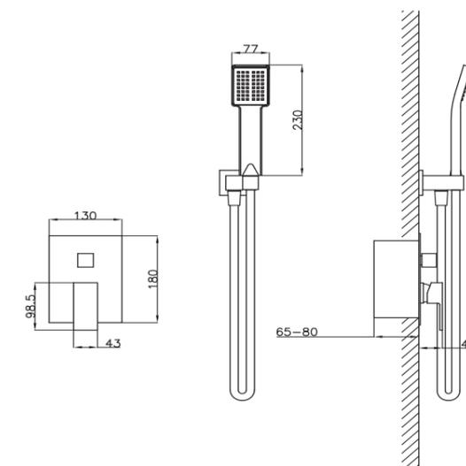
Conjunto de ducha monomando empotrado de 2 vías. Rociador cuadrado de Acero Inox.S304 de 25cm. Ultrafino y antical. Soporte de mango de ducha orientable, con salida de agua a pared. Flexo de PVC 1,5m. Mango de ducha cuadrado. **Caja de registro incluida.** Profundidad para empotrar 65-80mm.
